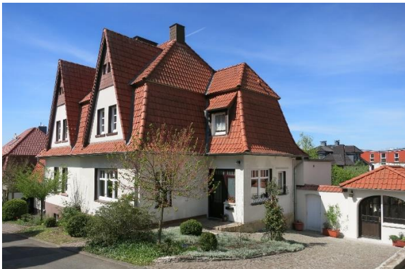
Mansardenwalmdach mit steilen Giebelgauben
